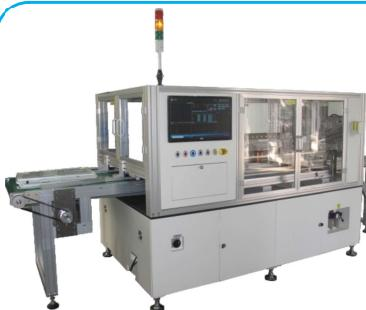
流水线不停线,追踪装配/锁螺丝/拉铆钉/检测/打胶等
