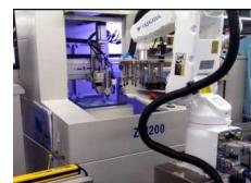
机器人测试自动上下料机
